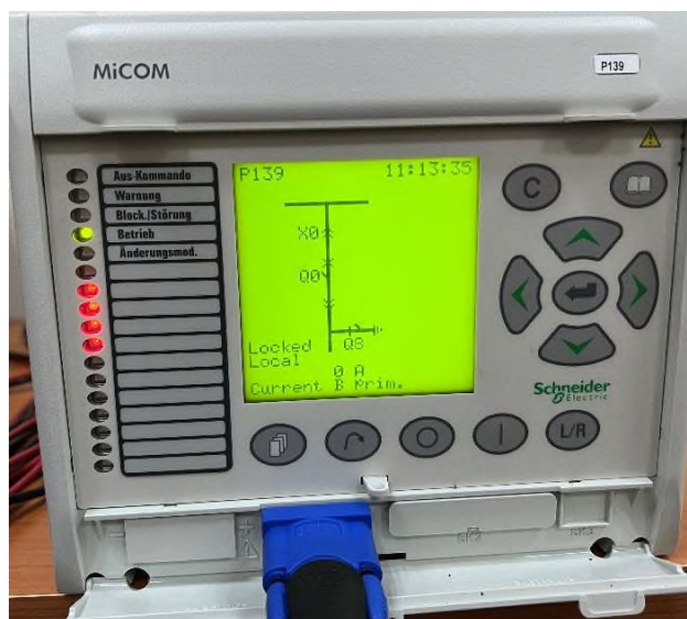
Рисунок 10 - Срабатывание ступеней АЧР, внешний вид МП термина MiCOM P139
