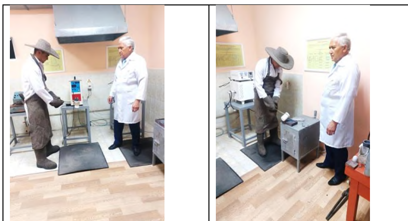
Рисунок 1 – Индукционный лабораторный печь и процесс литья отливок сплавов алюминия системы Al-Si-Me.
